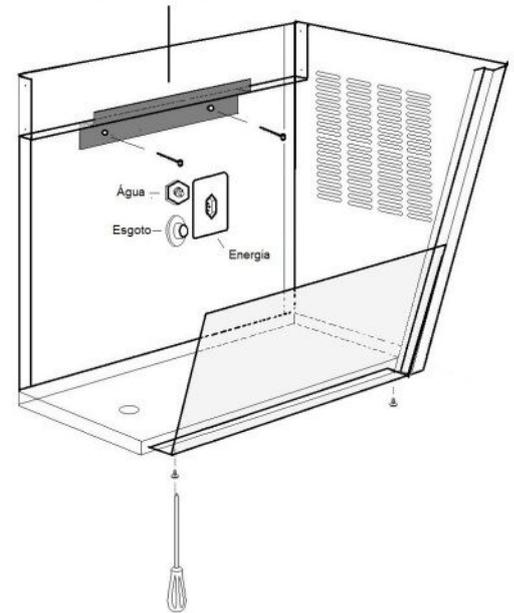
Após fixar o bebedouro, retire o tampo frontal com chave philips e faça as ligações das mangueiras de água, esgoto e cabo de energia.
