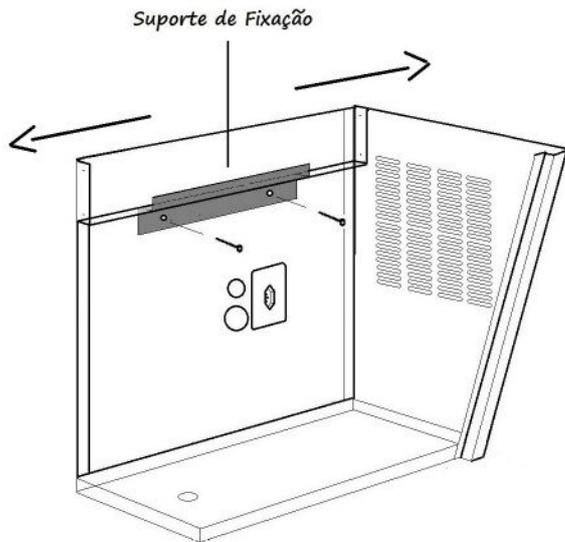
Colocar o conector na luva de entrada de água antes da fixação bebedouro na parede.
